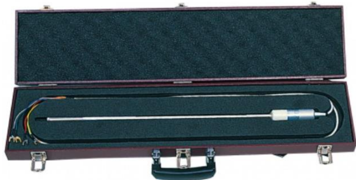
Termómetro patrón de resistencia de platino, SPRT; Funda de inconel Alfa: 0.003925
