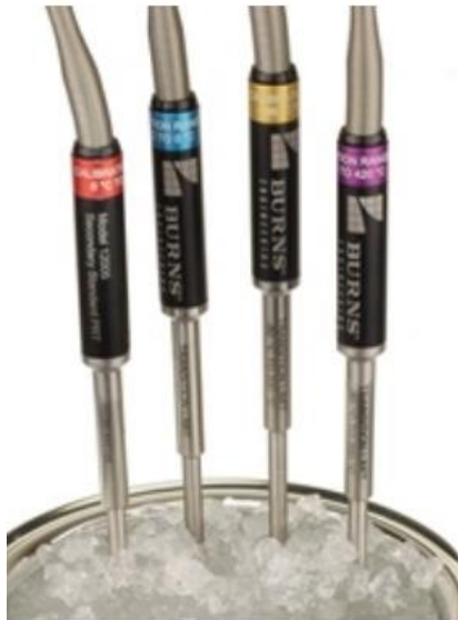
Termómetro patrón de resistencia de platino, secundarios Funda de METAL Alfa: 0.003925
