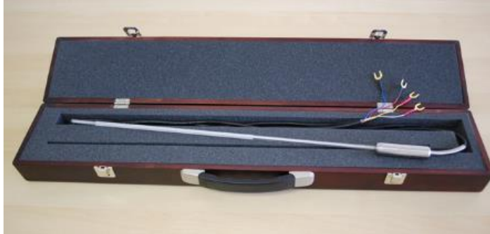
Termómetro patrón de resistencia de platino, SPRT Funda de cuarzo Alfa: 0.003925
